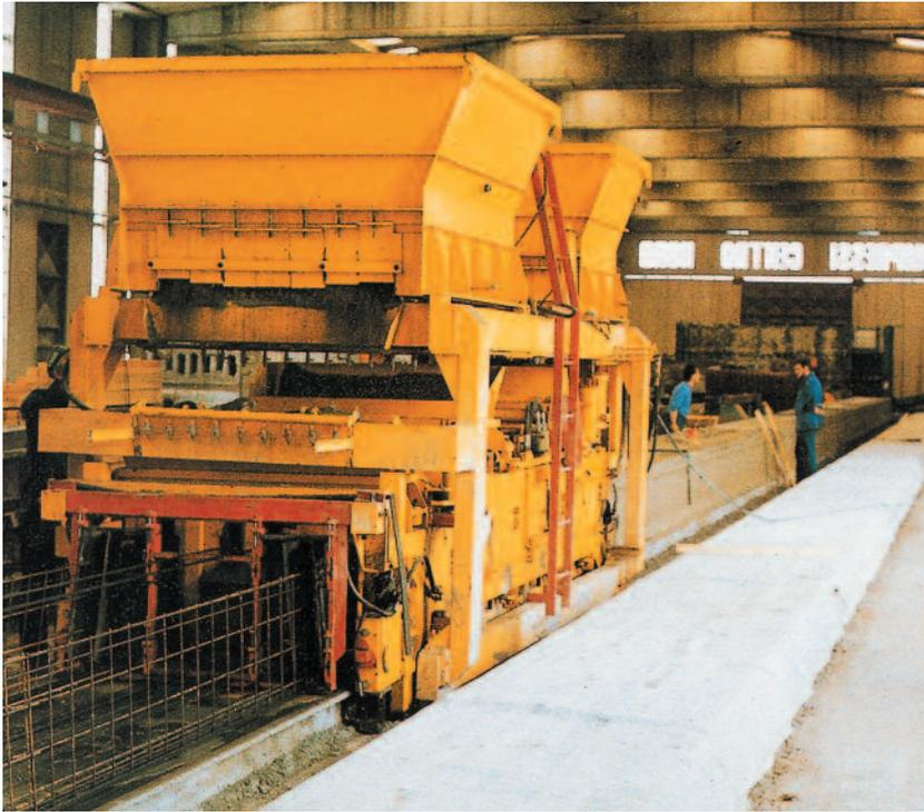
Fig. 2.1 Máquina moldeadora (procedimiento “slipform”)
