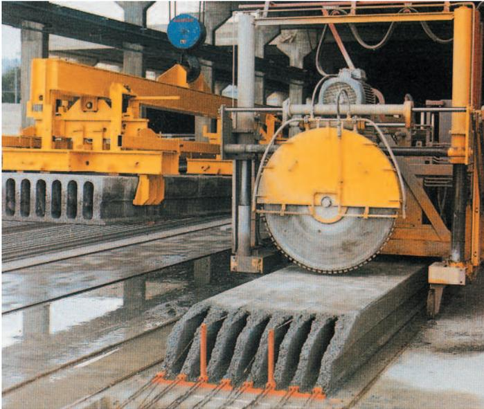
*Fig. 2.5 Corte de las losas y traslado desde la pista de moldeo*
