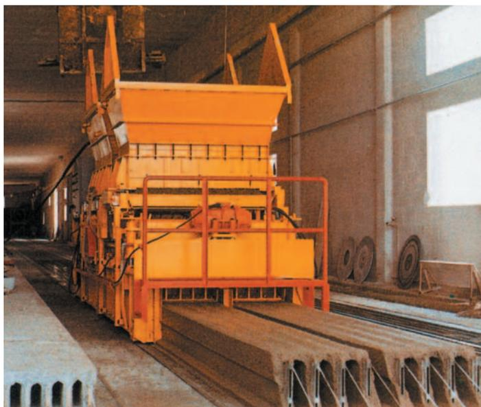
*Fig. 2.4 Vertido continuado del hormigón*
