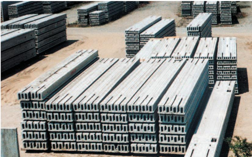
*Fig. 2.6 Explanada de acopio de las losas huecas*
