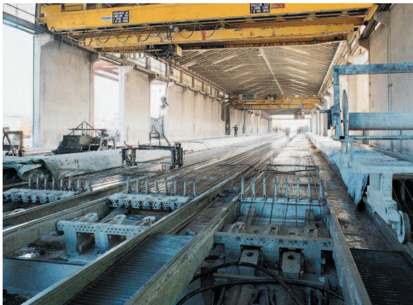
*Fig. 2.3 La armadura de pretensado tesada sobre la pista de moldeo*
