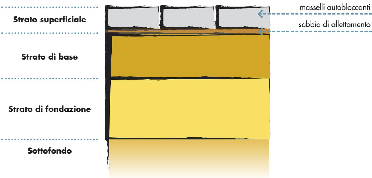
fig.1.1 - Sezione tipo di una pavimentazione in masselli autobloccanti
