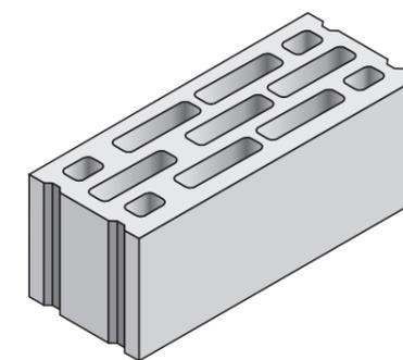
Fig. 2 - esempio di blocco multicamera
