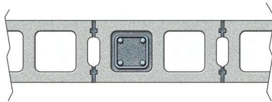
Irrigidimento ottenuto con l'inserimento di ferri entro le cavità dei blocchi. La resistenza flessionale va valutata in base alle regole della statica o per via sperimentale.
