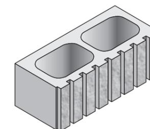
Fig. 4 - esempio di blocco a spacco sagomato
