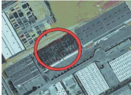
Fig. CS9.1 Immagine vista dall'alto del magazzino ubicato a nord di Rognac, vicino a Marsiglia. Si vede come l'incendio si sia diffuso all'intero edificio privo di pareti tagliafuoco (per gentile concessione di SDIS 13, Fire and Rescue Service, Bouches du Rhone, Francia).
